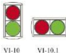
Семафори за регулисање приступа возила користе се за означавање одређеног прилаза, који може бити отворен, односно затворен.
